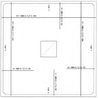
CX D'ÁGUA - ARMADURA - FORMAS DA TAMPA
